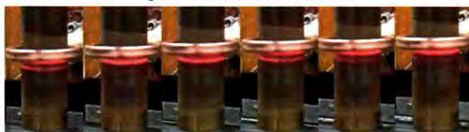
Рис. 1. Автоколебания температуры под индуктором при сканирующем нагреве цилиндра из магнитной стали
