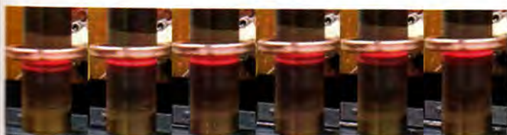
Рис. 3. Автоколебания температуры под индуктором при сканирующем нагреве цилиндра из магнитной стали
