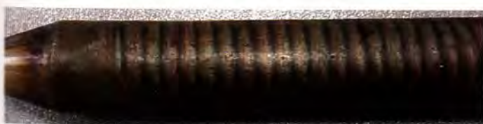
Рис. 4. Спиральный след на поверхности цилиндра из магнитной стали после сканирующей закалки с вращением
