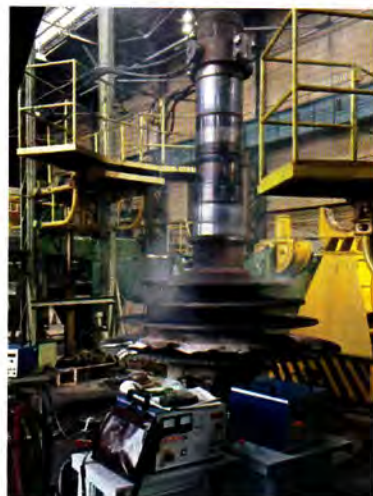
Рис. 6. Нагрев рабочего колеса ротора паровой турбины
