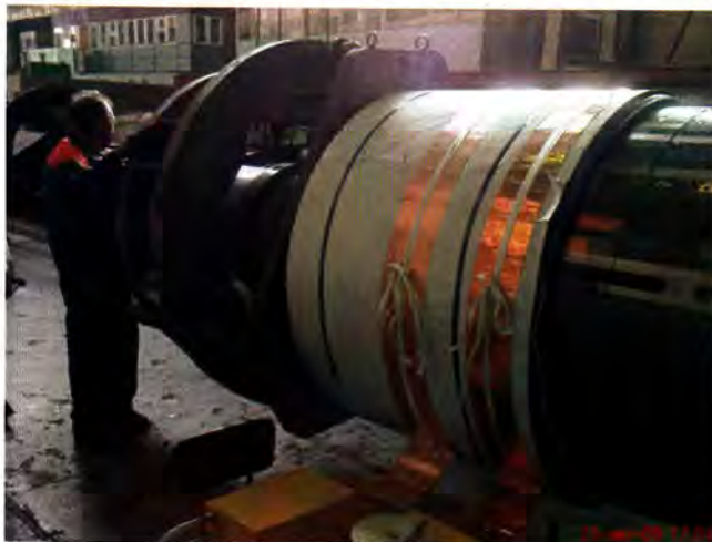
Рис. 5. Нагрев бондажного кольца ротора турбогенератора
