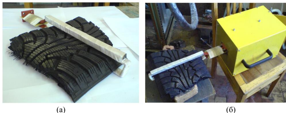
Рис. 8. (а) индукционная система на основе овального индуктора, (б) индукционная система и согласующее устройство
