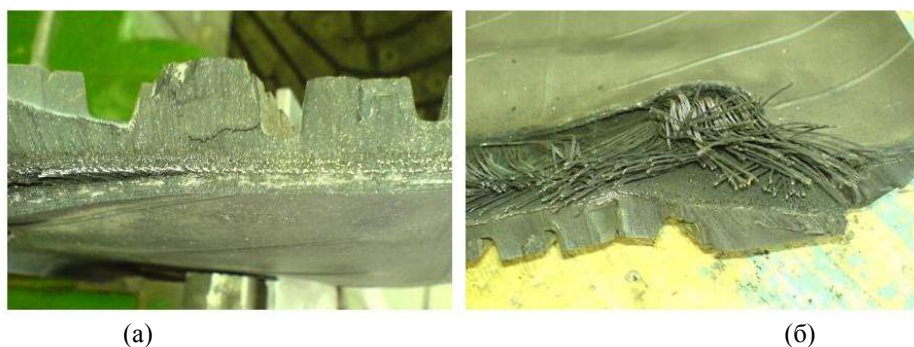
Рис. 9. Фото срезов автомобильной покрышки (а) до нагрева, (б) после нагрева
